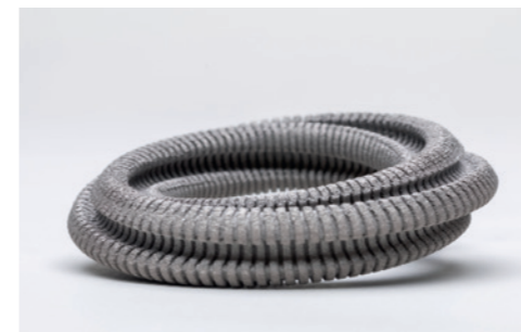
BAUTEIL: Geometrie-Modell WERKSTOFF: Titan / as-built
